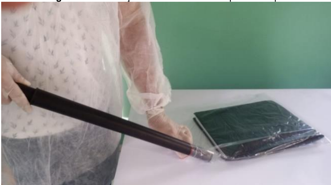
Figura 9 – Evacuação do ar com uso de aspirador de pó
