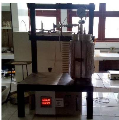
Figura 19 – Reator de aço Maitec
